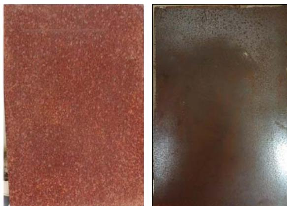
Figura 3. Painéis de aço AISI com grau C de enferrujamento (à esquerda) e após tratamento C St3 (à direita)
