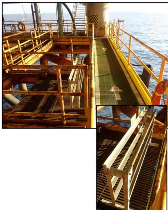
Figura 7. Estante para instalação dos corpos de prova
