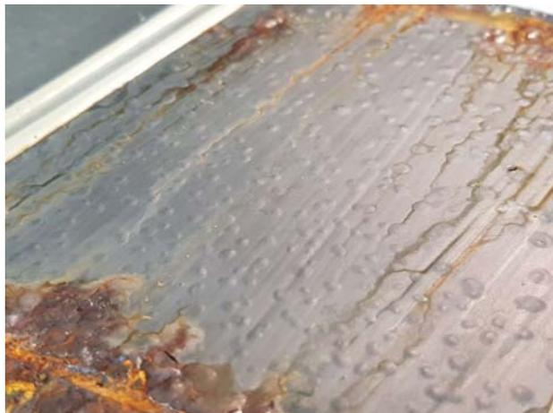
**Figura 12. Empolamento generalizado observado no esquema de pintura PoliCoating 8090**
