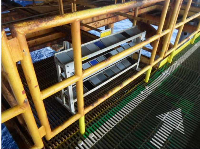
**Figura 8.** Estante com os corpos de prova instalados a bordo da plataforma PPG-1
